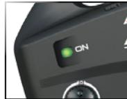
Wenn die Status-LED rot blinkt, sind eventuell die Batterien des Senders schwach, entladen oder nicht richtig installiert. Ersetzen Sie sie mit neuen oder frisch geladenen Batterien. Die Anzeigelampe zeigt nicht den Ladezustand der im Modell installierten Batterie an. Mehr Informationen über Sender, Statusanzeige und LED-Signale finden Sie auf Seite 15 im Abschnitt Fehlerbehebung.
