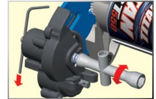
Zum Einstellen der Rutschkupplung muss die Abdeckung der Empfänger-Box abgenommen werden. Danach lösen und entnehmen Sie die eine große Sechskantschraube mit einem 2,5 mm Schlüssel. Drehen Sie anschließend den Motor und befestigen Sie ihn an der Seite des Modells. Die Rutschkupplung ist im Hauptzahnrad des Getriebes integriert.
